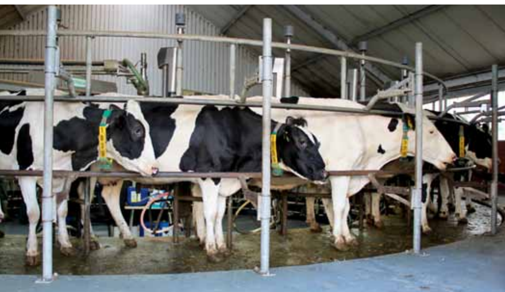
Im GEA-Melkkarussell mit 28 Plätzen wird dreimal täglich gemolken.
